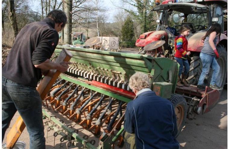
Otto und Marc beim Vorbereiten der Sämaschine. Für jedes Saatgut muss die Sämaschine anders eingestellt werden. Das Saatgut wird genau abgewogen und fällt bei der Fahrt durch Röhren in die Ackerfurchen.
